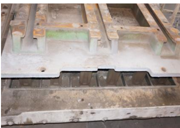
Blokstens form inden rengøring
